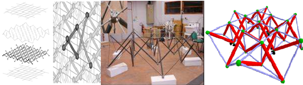
Figure 1 : Principe de conception, la minigrille, sa modélisation.
